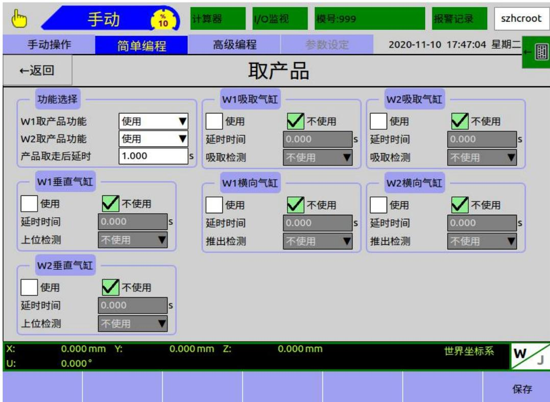
系统内置了一套工作台 1 (W1) 和工作台 2 (W2) 的取产品动作逻辑，每个工作台有三个气缸可选用，分别为“垂直气缸”、“吸取气缸”和“横向气缸”，三个气缸对应的检测信号为“上位检测”、“吸取检测”和“推出检测”。
